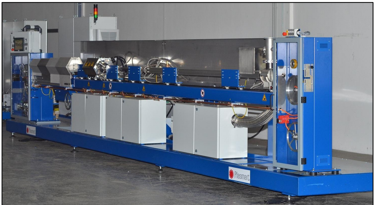
Abbildung 6. Plasmaglühofen für Hochgeschwindigkeitsglühen von Drähten oder Litzen aus Edelstählen Nickelbasislegierungen.
