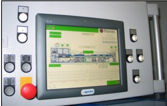
Abbildung 5. Bedienpult mit Siemens SPS und Spectra Visu.
